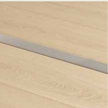
PROFIL DYLATACYJNY 2000 × 34 × 7 mm Służy do zakrywania szczelin dylatacyjnych pomiędzy dwiema podłogami o tej samej wysokości. Powierzchnia: aluminium. SFEXPSILV | SFEXPCOFF | SFEXPCLAY | SFEXPCHAM | SFEXPBLACK
